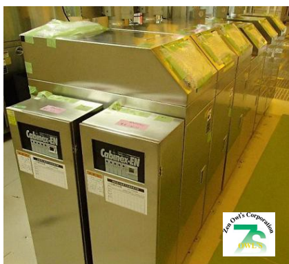
薬液供給回収ユニット
